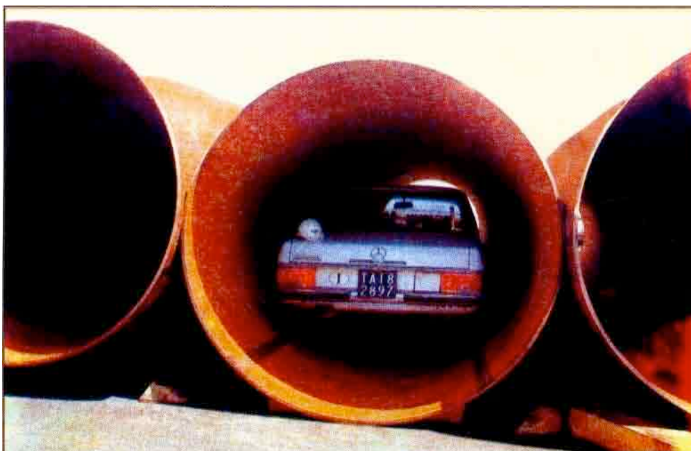
Экспериментальные трубы диаметром 2,5 м, изготовленные по технологии германской фирмы «Тиссен» (экспонат Международной выставки <<Ин-тергаз->). Москва, 1970 г.
